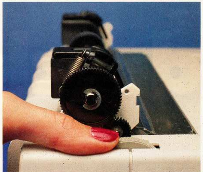
Gefährlich: scharfe Zahnräder und das kleine Transportrad erschweren die Arbeit (Brother M 1109)
